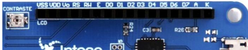
Imagen 6. Fotografía del puerto de expansión para Display LCD.
