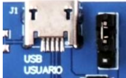
Imagen 10. Jumper para seleccionar el puerto Micro USB a utilizar.
